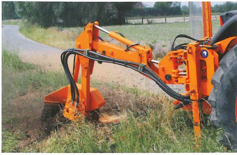
Zelfde werkingsprincipe als een mini graafarm.
