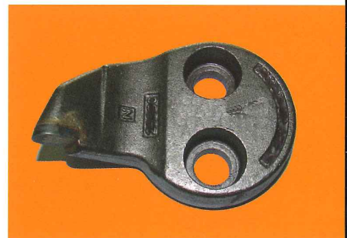
De freestanden zijn voorzien van een laagje TUNGSTEEN CARBIDE.
