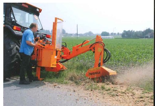
Optimale zichtbaarheid op het werk – bestuurderspost bevindt zich achter een plexiglas scherm.
