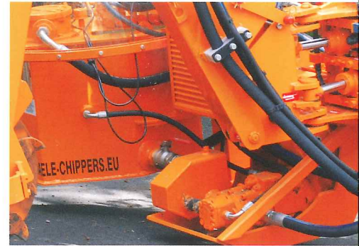
Geïntegreerd hydraulisch circuit: pompen, olietank, oliekoeler.
